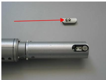
Imagen 2. DRT-Rückseitenschrauben
