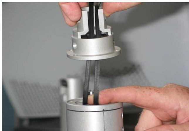
Imagen 8. Flachriemens in zwischen Rollen und Spannerwand
