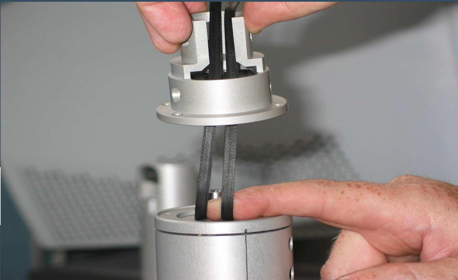
Das DRT-Werkzeug verfügt über ein L-Riemen-Antriebssystem, das die Bewegung vom Motor auf die Messerwelle überträgt.
